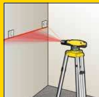
◀ Nivelção e alinhamento horizontal e vertical
